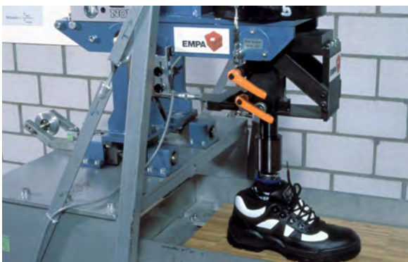
Abbildung 1 Boden- und Schuhtester BST 2000, EMPA St. Gallen
